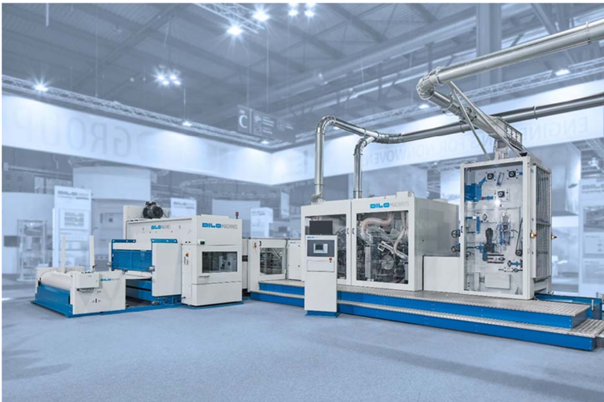
DCL Dilo Kompaktanlage, Arbeitsbreite 2,2 m
