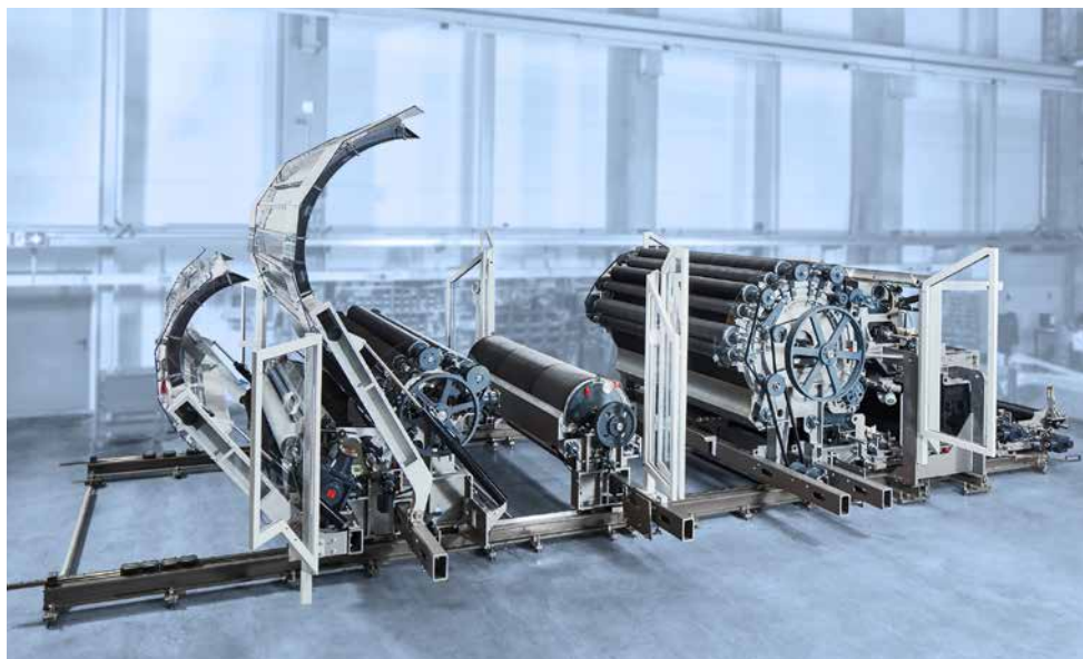
Dilo Spinnbau: 配备特殊抽吸系统的多功能梳理机
